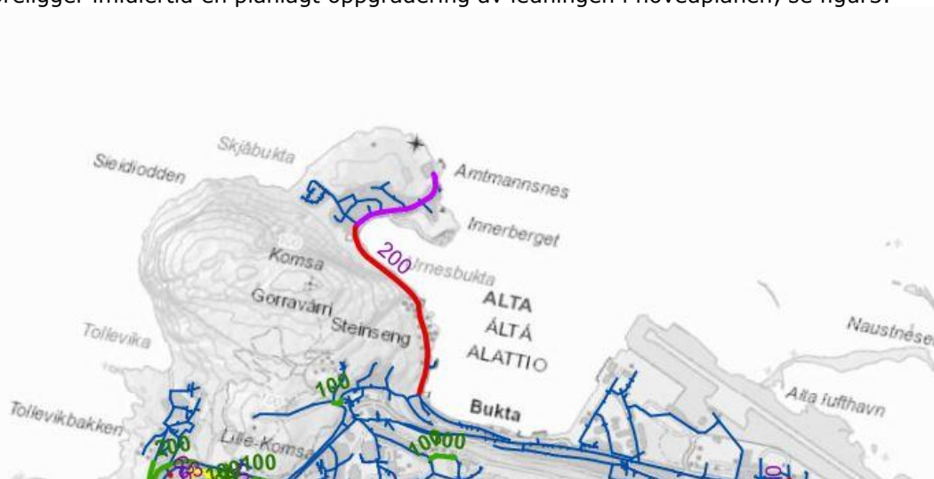
Figur 3: Fra hovedplan vann, figuren viser at det er planlagt en oppgradering av ledningen fra Bukta til Amtmannsnes. Rød ledning har prioritet 1, lilla ledning har prioritet 2.
