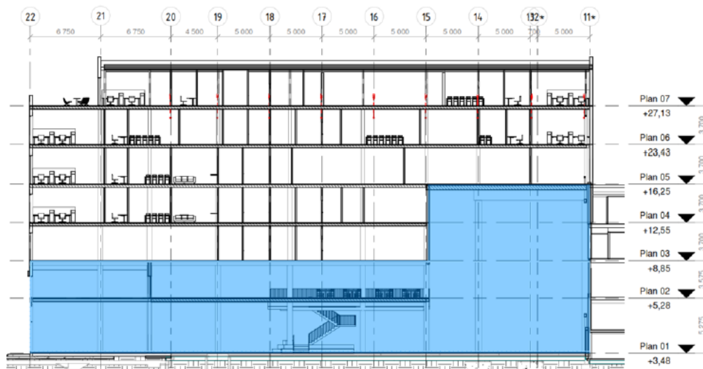
Figur 1: Snitt som viser fordeling av kontor (hvit farge) og idrettsanlegg/klatrehall (blå farge). Kilde planbeskrivelse Klatrehall Grandfjæra.
