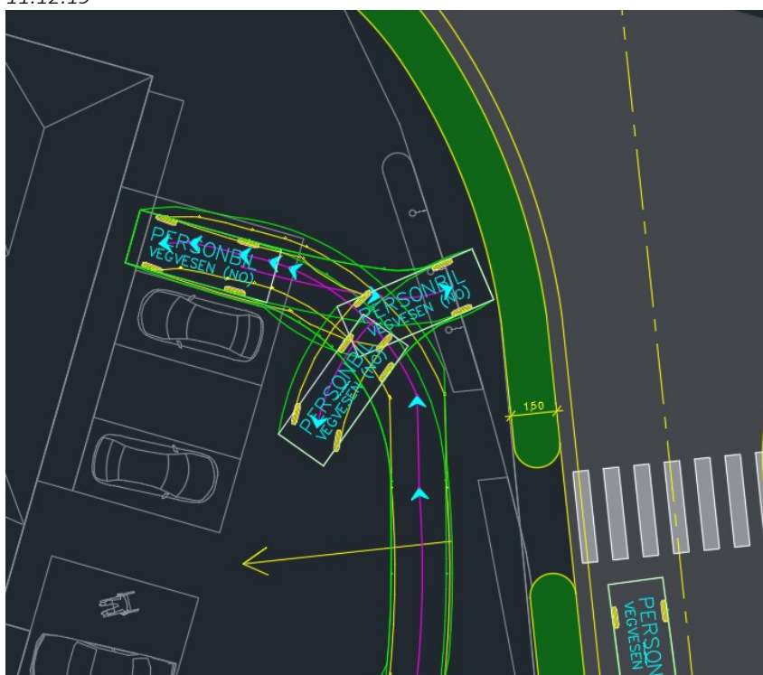
Figur 13 Utklipp av arbeid med skissering av løsning for sikker krysning av KV1065. Skisse av Multiconsult 11.12.19
