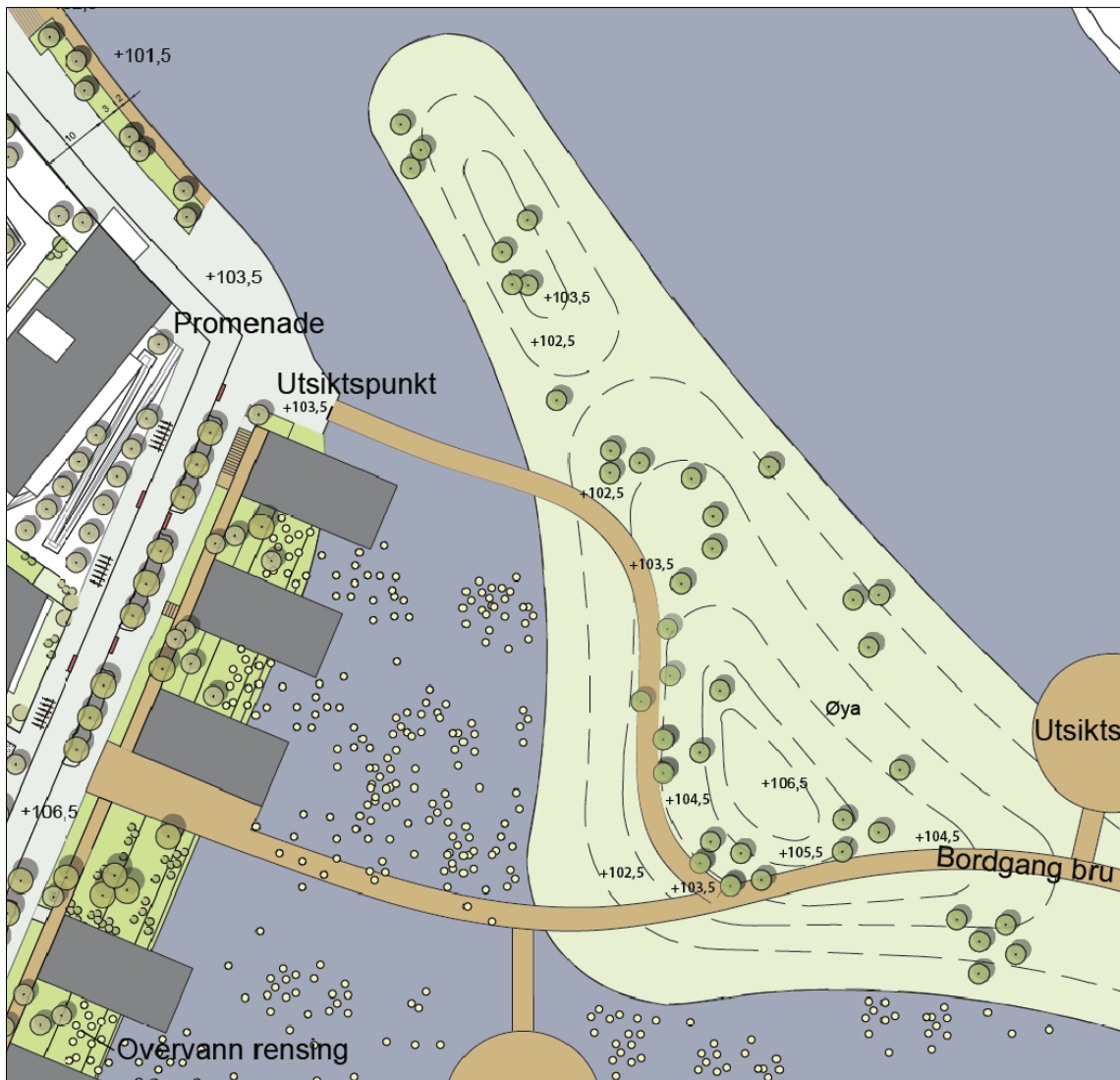
Bilde 3 viser skisse av alternativ med ny broforbindelse fra øya og direkte til elvepromenaden.
