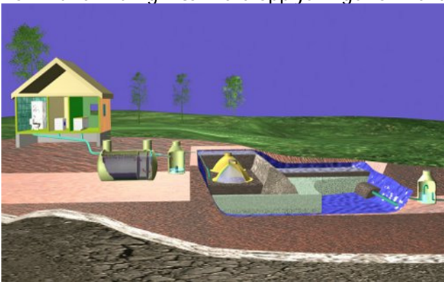
Prinsippkisse av våtmarksfilter med forfilter. (Kilde: www.avlop.no )
